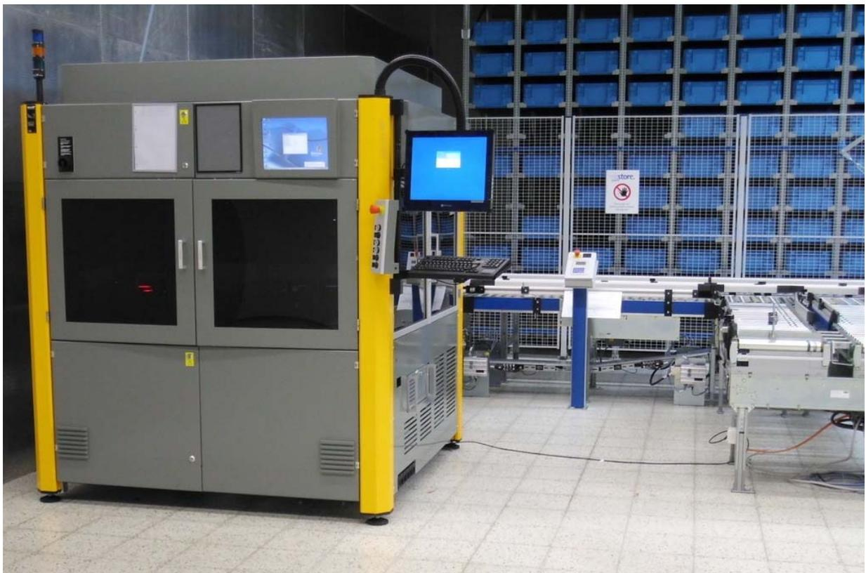
Der Kalibrierroboter für Messschieber und das automatische Hochregellager für Temperierung und Zuführung.
